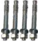
Fixankersatz ( 4 Stück ) **M16 x 130 mm**, verzinkt, für Betonfundamente, geeignet für Rammeschutzpoller Ø 152 bis Ø 273 mm zum Aufdübeln
