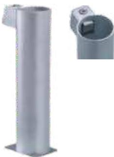
Bodenhülse aus feuerverzinktem Stahlblech, mit Ankerplatte und Klemmkeil aus Guß. Bedienung mittels Inbusschlüssel. Für alle Röhre und Schilderpfosten mit Ø 60 und Ø 76 mm geeignet
