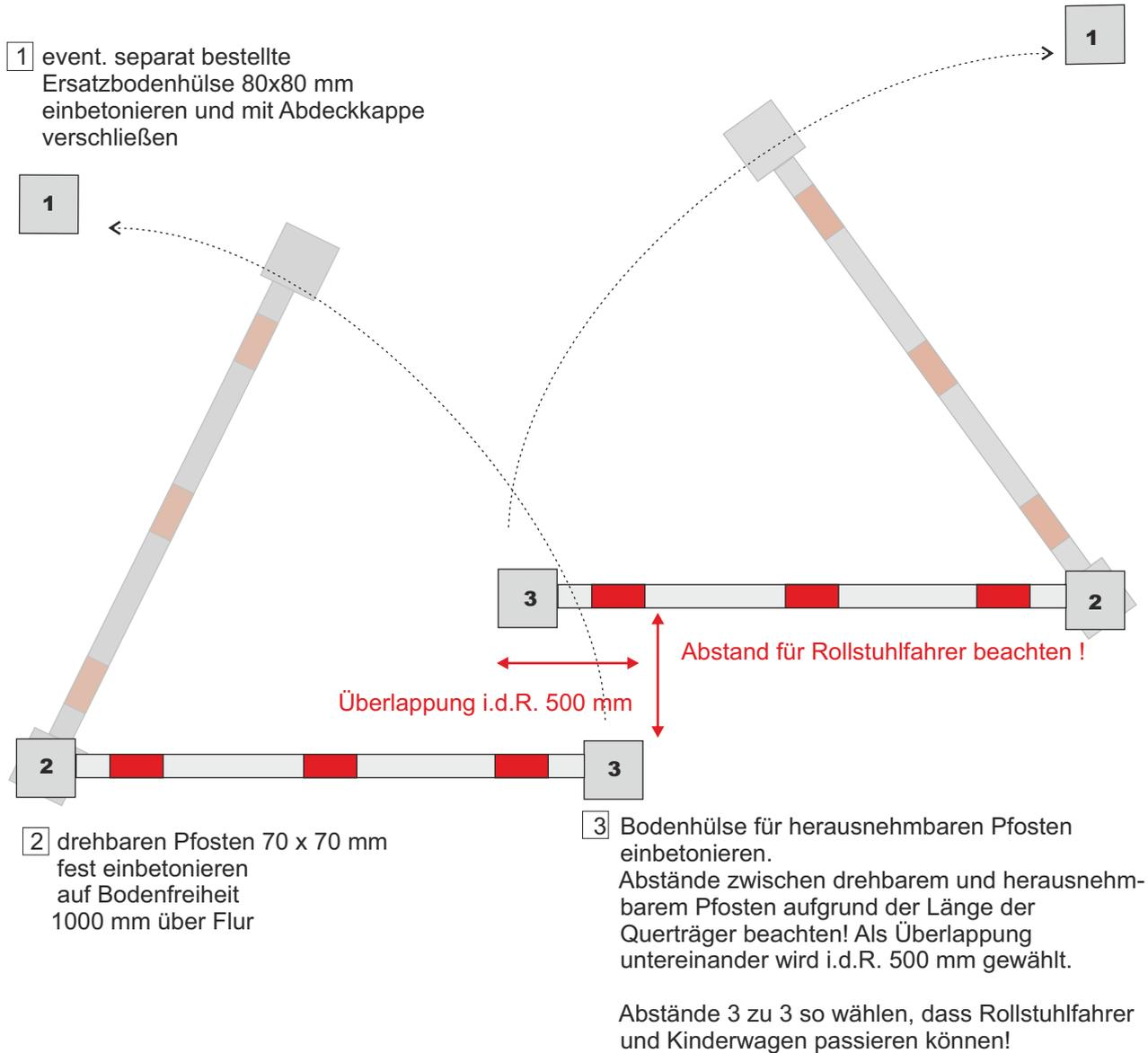
Nach Einbau den drehbaren Pfosten so einstellen, dass er nach Verschraubung mit den Querträgern um 90 Grad drehbar ist. Zur Sicherheit sollte der herausnehmbare Pfosten immer in eine der Bodenhülsen 1 oder 3 verriegelt sein. Die jeweils nicht benutzte Bodenhülse sollte durch die Abdeckkappe verschlossen sein! Bodenhülse ca. 2 - 3 mm über Flur setzen und unter der Bodenhülse ein Kiesbett von 200 mm Tiefe zum Wasserablauf vorsehen. ( siehe Montageanleitung herausnehmbare Pfosten )
